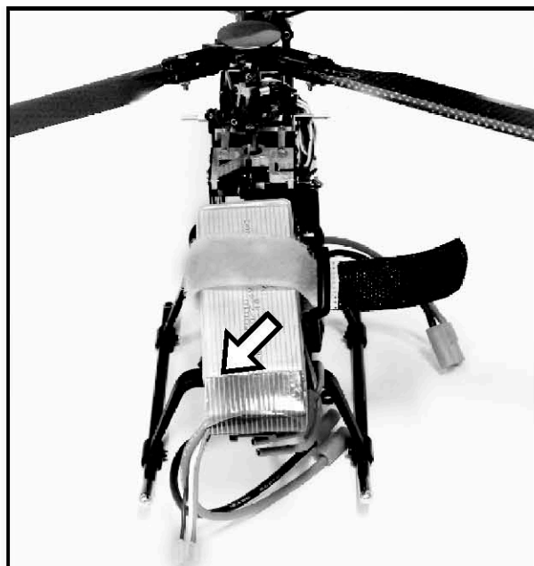
Retire el pack de baterías
