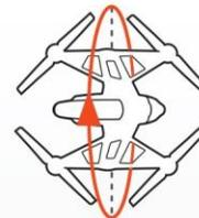
**Paso 8)** Volver a rotar el aeroplano 45 grados a la izquierda. Después, rotar despacio el aeroplano 360 grados sobre si mismo, como indica el dibujo, hasta que vuelva a estar recto y erguido en sus manos.
