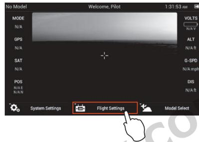
**Paso 5)** Si es necesario, toque la pantalla (fuera de la pantalla emergente de estado) para evitar el proceso de conexión del RC y la WiFi, entonces toque el botón "Flight Settings" y, si es necesario, presione "OK" para evitar cualquier alerta/advertencia emergente.
