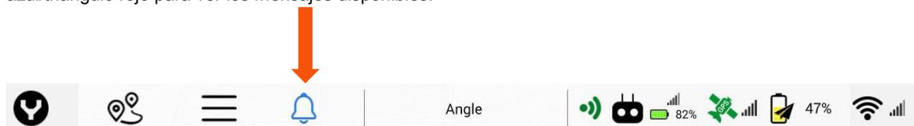
La tecla programable Modo de Vuelo (Flight Mode) permite al piloto cambiar los modos de vuelo del H520 entre ÁNGULO y MANUAL (para más información sobre Modos de Vuelo, consultar la sección [Modo de Vuelo \(Flight Mode\)](#) de este manual).
